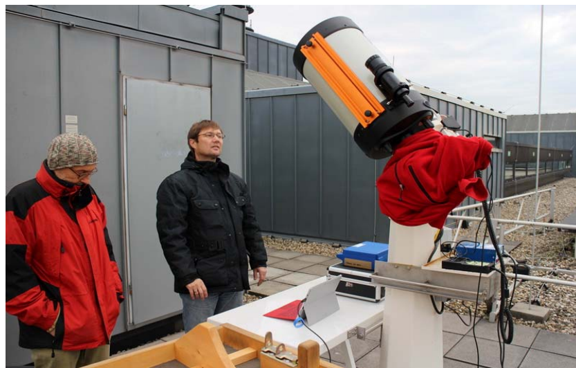
Nein, Spektrographen frieren nicht; der Pullover soll bei Tag das Eindringen von Streulicht in den LHires III Spektrographen verhindern
