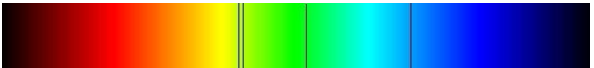
Abb 2c Absorptionsspektrum von Hg
