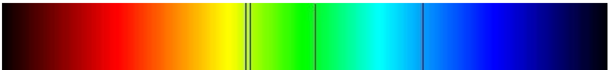
Abb 2c Absorptionsspektrum von Hg
