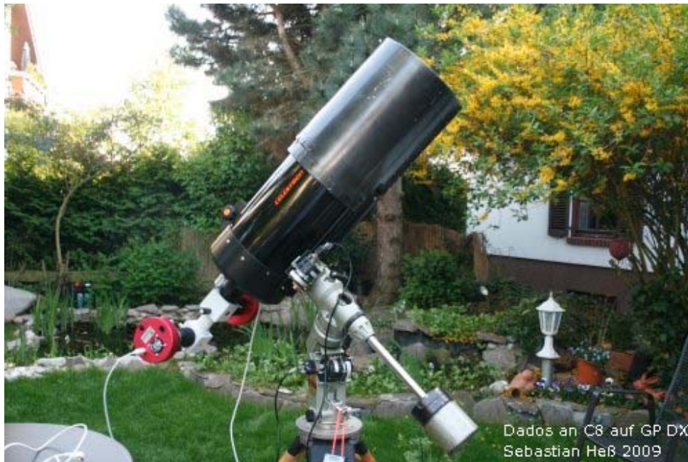
Abb. 1: Der DADOS Spektrograph, montiert am C8 des Verfassers
